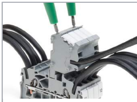
Wielowtyki TOPJOB® S są wyposażone w gniazdo pomiarowe (o średnicy 2 mm), w którym można dokonywać pomiaru napięcia przy użyciu 2-biegunowego miernika.
